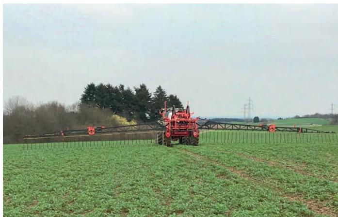
Alle Maschinen mit 3000 l Inhalt, Frischwassertank 300 l, Handwaschtank 20 l, Pumpe 262 l / 20 bar, vollhydr. Klappung mit variabler Geometrie, hydr. Hangausgleich, 7 Teilbreiten (9 bei 27 m), hydr. Parallelogrammführung, hydr. Federung des Gestängeträgers, 3-fach Düsenräger mit Lechler Düsen, Steuerung Isobus Elektronik, Obenanhangung mit vollelektr. Lenkdeichsel, Druckluft-Bremsanlage, BPW-Achse mit TÜV-Gutachten 40 km/h, Beleuchtung, Bereifung 340/85 R48 mit Kotflügel.
